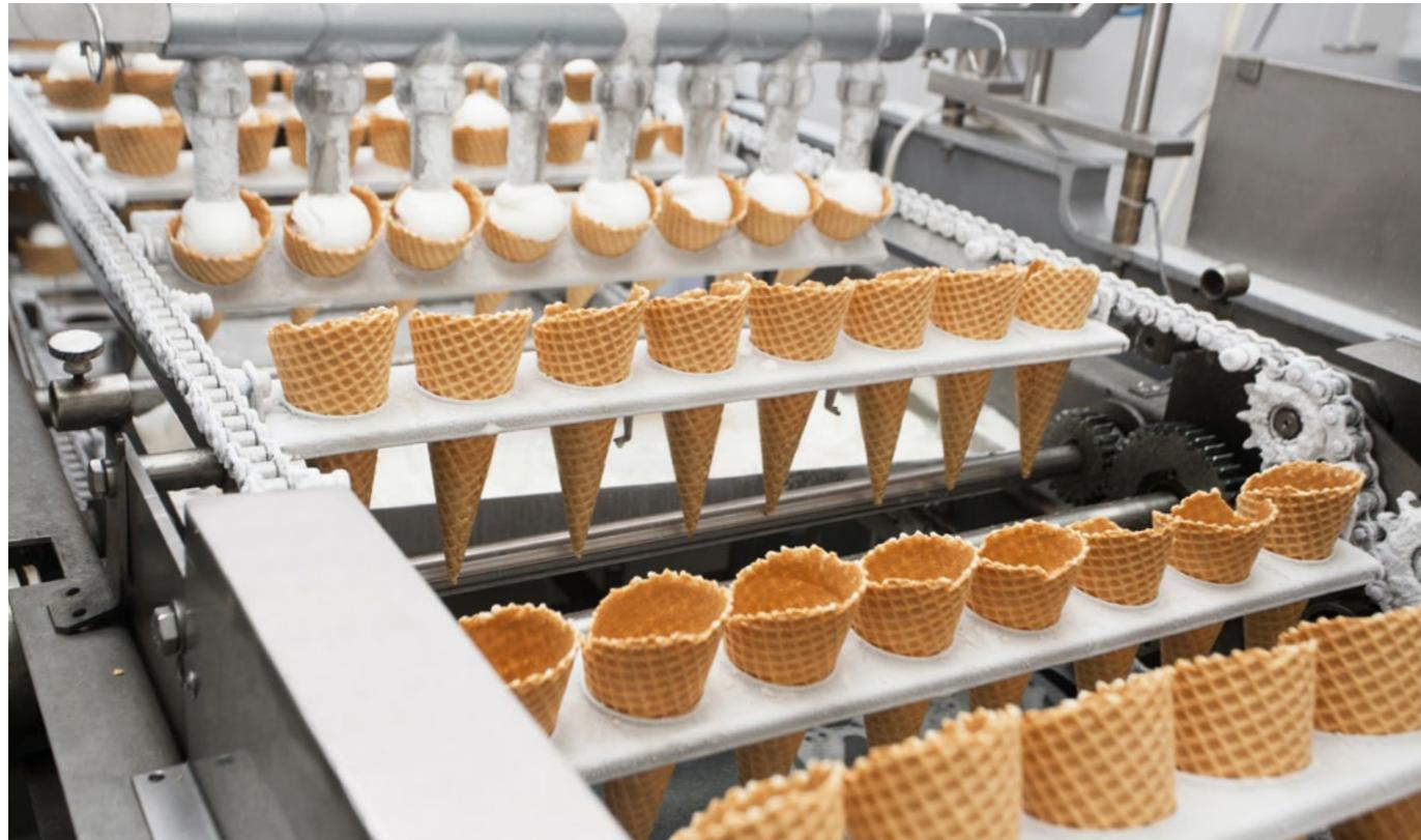
Fødevaregodkendte smøremidler er anvendt til smøring, kraftoverførsel og korrosions beskyttelse af maskiner for at fremstille og bearbejde fødevarer, fødevare relaterede råvarer, kosmetik, farmaceutiske produkter, tobak produkter og dyrefoder.
